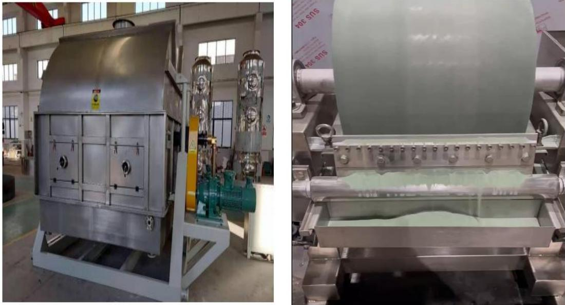
图 4.2-2 滚筒刮板干燥机样品图
