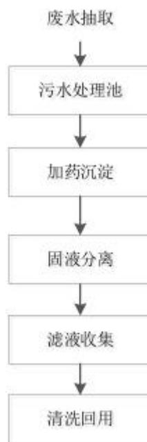
图 4.2-1 本项目印刷清洗废水处理工艺流程图
